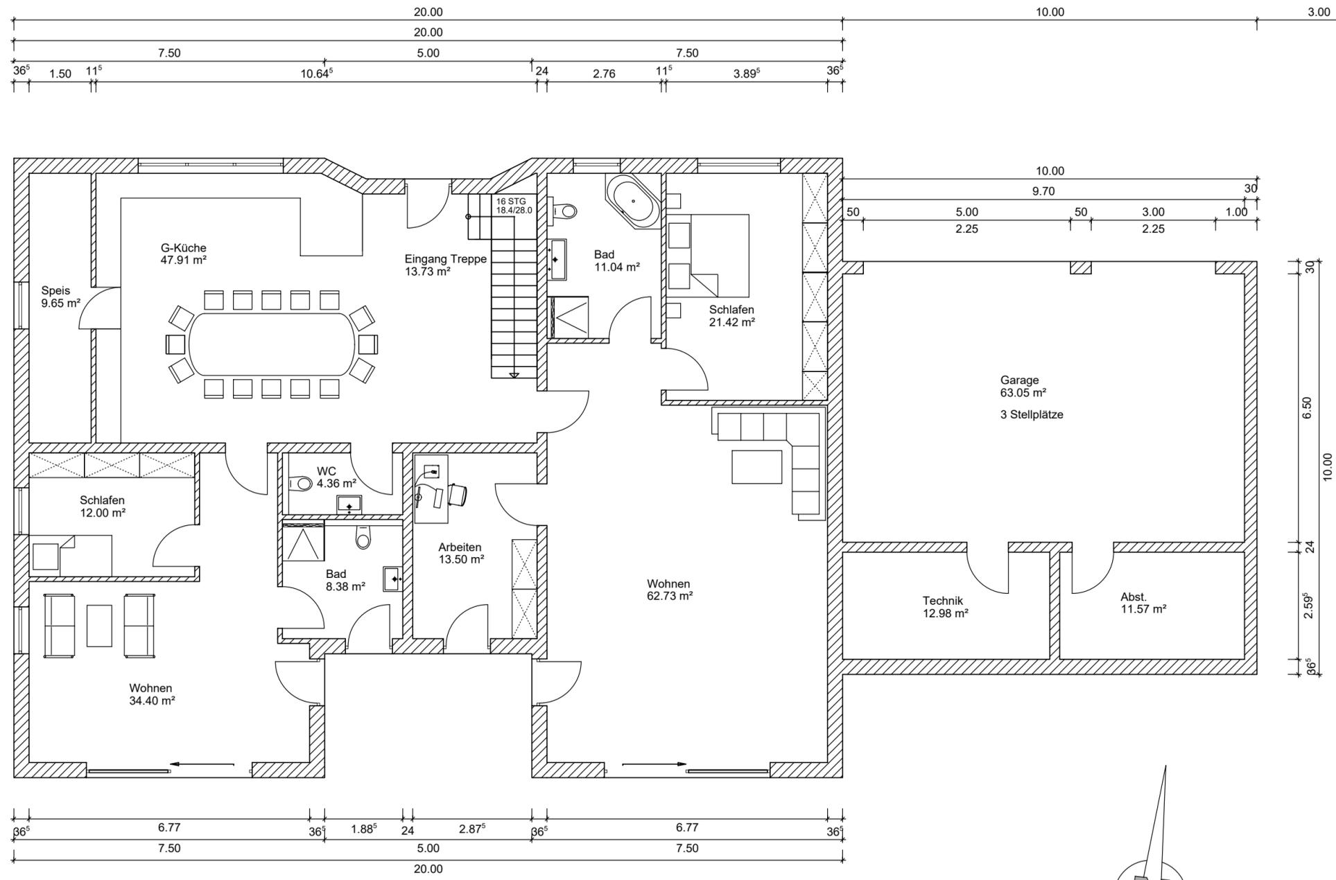
**Grundriss Erdgeschoss Mehrgenerationenhaus**
